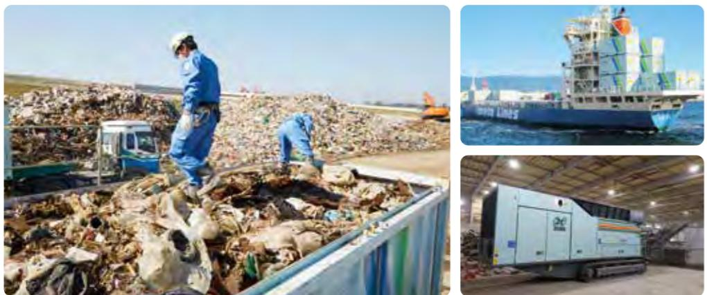
左／仮置き場にてコンテナへの積み込み作業 右上／船舶による海上コンテナ輸送で広域処理を実現 右下／迅速な災害廃棄物処理を可能にする移動式破碎機
