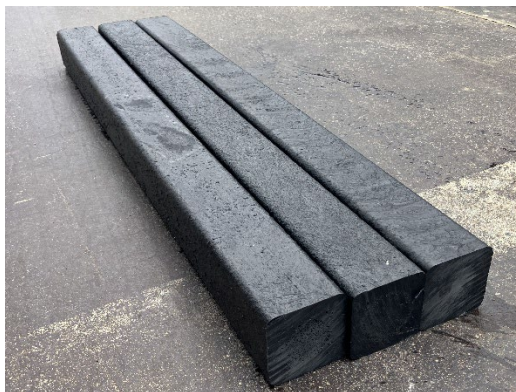
廃プラスチックから成形した角材(株式会社鴻池組提供)
