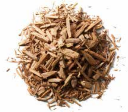
木質系廃棄物を選別、破碎した木質チップ。 大栄環境グループでは、バイオマス発電の燃料は輸入木材に依存していない。
